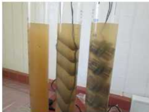
写真 濁水の沈降試験
